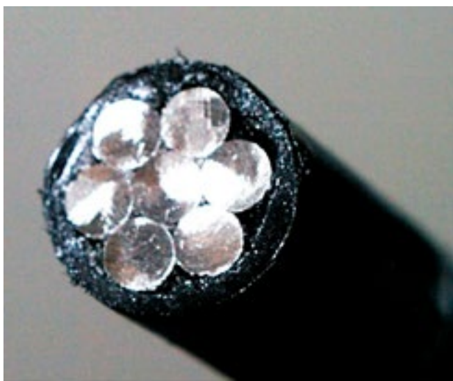
Obr. 2 – průřez předpínacího lana.
