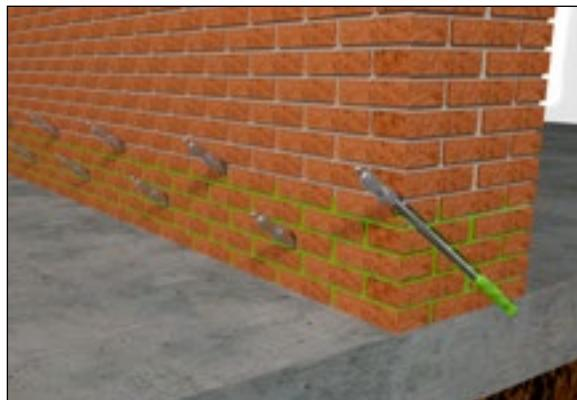
Znázornění otvorů vrtaných z vnitřní a vnější části. U stěn s tloušťkou nad 80 cm vrat oboustranně.
