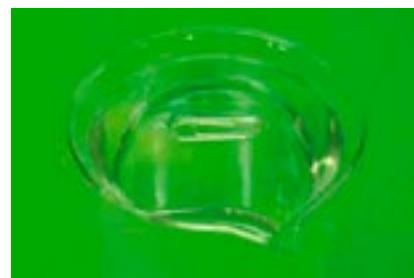
Vzlínající vlhkost je jev způsobený povrchovým napětím kapaliny (koheze) a mezistěnovým napětím (adheze) mezi kapalinou a pevným povrchem. Obecně má kapalina tendenci se rozprostřít, když přijde do kontaktu s povrchem. Na druhé straně má kapalina povrchové napětí. Tyto dvě síly dohromady vedou k efektu, že voda vzlíná v úzkých kapilárách (viz obrázek).
