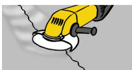
Obr. 1 Broušení a vyčištění povrchu trhliny
