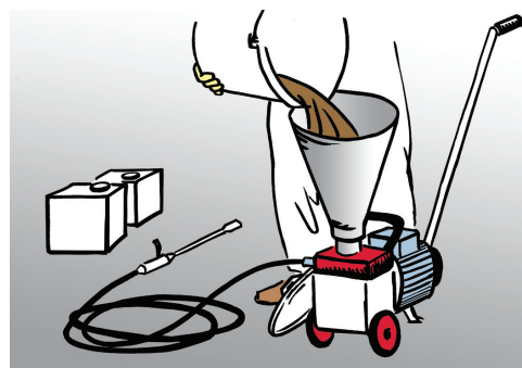
Obr. 11 Připravte si pumpu dle návodu výrobce. Naplňte rozmíchanou pryskyřicí do zásobníku. Rozmíchaný materiál musí být použit během své doby zpracovatelnosti.
