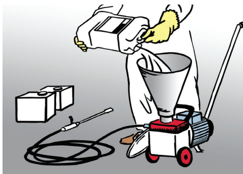
Obr. 13 Vyčistěte pumpu dle doporučení v manuálu. Po úplném vytvrdnutí injektážní pryskyřice odstraňte injektážní pakry a vyplňte vyvrtané otvory maltou.
