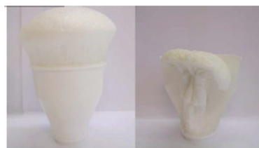
Obr. 1 Jednosložkové polyuretanové injektační pryskyřice s uzavřenými buňkami.
